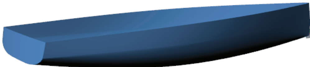
Rys. 1. Model powierzchniowy bryły kadłuba
